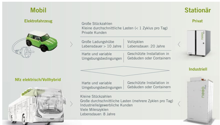
BILD 2 Anwendungen von Lithium-Ionen-Batteriesystemen mit ihren typischen Randbedingungen je nach den Segmenten Mobil für Pkw/Nfz (Nutzfahrzeug) sowie Stationär für Privat/Industriell (© Akasol)
