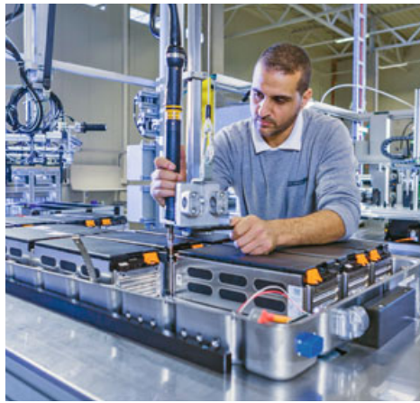
Die einzelnen Zellmodule werden auf dem Boden des Edelstahltrögs verschraubt.
