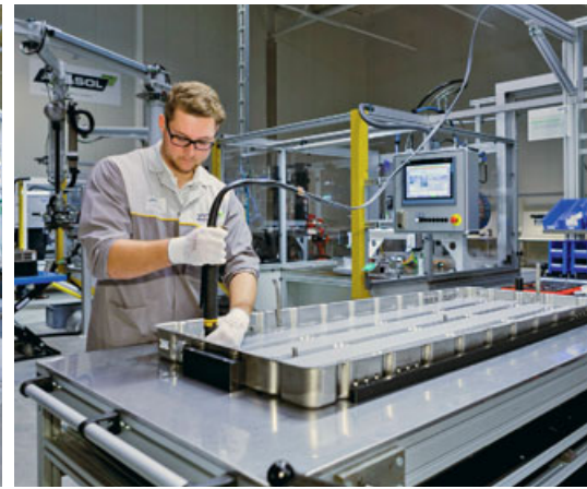
Schaumstoffmatten sorgen in den Edelstahltrögen der Batteriemodule für ein effizientes passives Thermomanagement.
