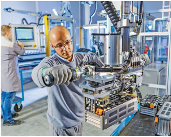
Die einzelnen Zellmodule werden bei Akasol in Edelstahltrögen zu Batteriesystemen zusammengefasst.
